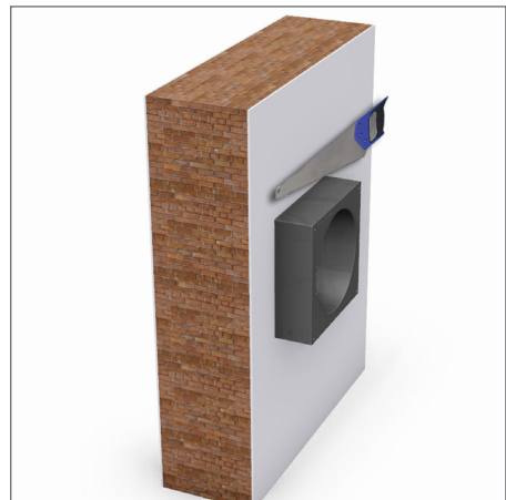
Fig. 4 - Raccourcissement final du tube de montage mural
