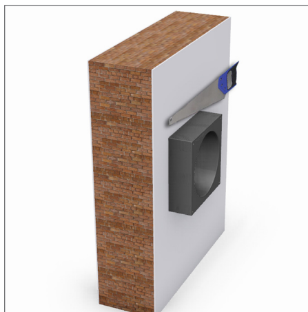
Fig. 4 - Accorciamento finale del tubo per montaggio a parete
