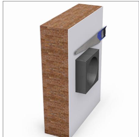
Rys. 4 - Skracanie przejścia do montażu w ścianie
